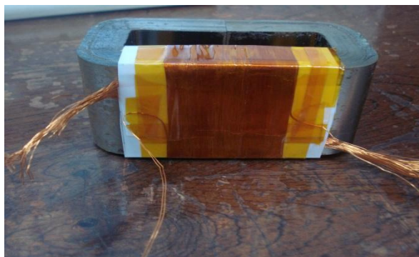
Fig. 2.2. Enrolamento secundário mostrado sobre o primário no núcleo de Metglass (AMCC 100).
